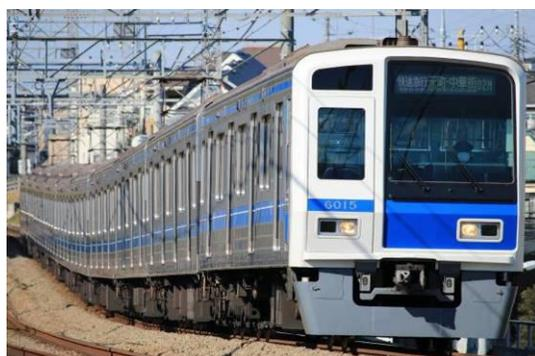
この車両は、1992年に西武池袋—東京メトロ有楽町直通線乗り入れ用として、東急車輛製造が製造したステンレス鋼製の地下鉄対応車両である。さらに現在は東京メトロ副都心—東急東横線—みなのみらい線直通の為、直通工事を行った。
