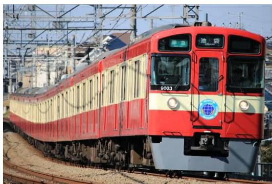
9000系は、2000N系と同じ普通鋼製で黄色の塗装をしている。しかし、貫通扉が2000系とは異なり、黒色になっていたり若干2000系とは異なる。当車両は2007年までにVVVFインバータ制御に更新しており、省エネルギー化が進んでいる。また現時点で最後に製造された黄色い車両である。なお、右写真の9000系9003編成(赤い電車)は、京急とのコラボレーション車両で、西武鉄道では「RED LUCKY TRAIN」と呼ばれている。逆に京急線では、西武線とのコラボレーションで「KEIKYU YELLOW HAPPY TRAIN」という黄色い電車が運行されている。
